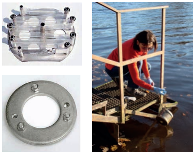
Obr. 3 Různé typy pasivní vzorkovačů (pro lipofilní nebo hydrofilní látky) a jejich instalace do toku
